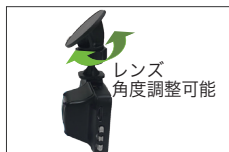
レンズの角度を調整し、電源、リアカメラのケーブルを配線し microSD カードを挿入する。
